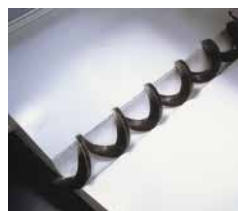
Šroub pro odstraňování třísek z vnitřního prostoru stroje. Jednoduché zařízení, které dopraví třísky k vynašeči.
