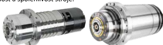
Vřeteno s přímým pohonem a rychlostí 10 000, 12 000, 15 000 nebo 18 000 ot.min -1
