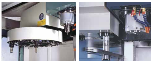
Automatizovaný zásobník nástrojů je možné zvolit buď karuselový nebo bubnový s výměnnou rukou. Oba typy výměny nástroj velmi rychle.
