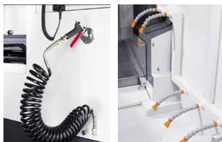
Ostříkovací pistole pro snadné čištění obrobku a vnitřních částí stroje od třísek, přídatné trysky pro oplachování zadního krytu.
