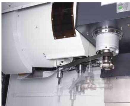
Karuselový zásobník nástrojů a bubnový zásobník nástrojů s výměnnou rukou
